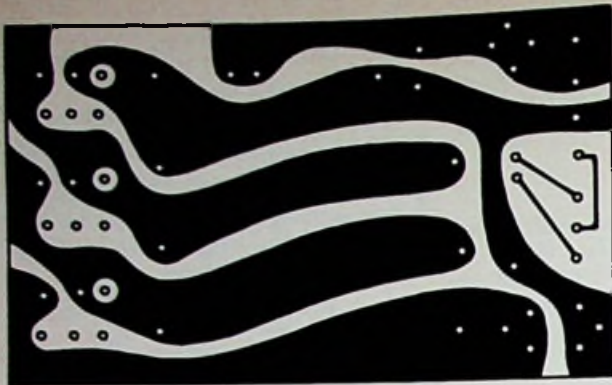
Fig. 11b. Koperszijde van de print voor de stroombegrenzing
